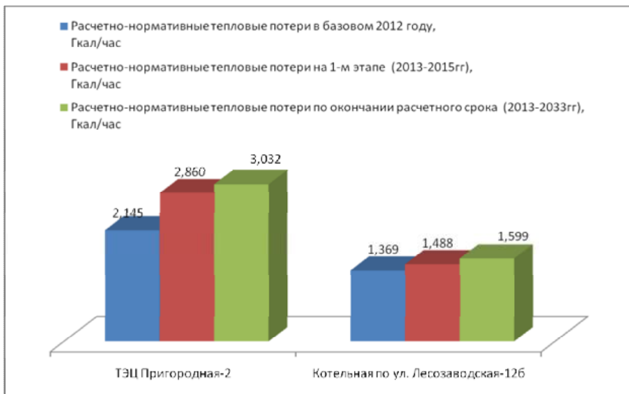
Рисунок 2.3.2. Существующие и перспективные расчетно-нормативные тепловые потери через изоляционные конструкции теплопроводов и потери теплоносителя в системах теплоснабжения крупных источников тепла в г. Холмске.
