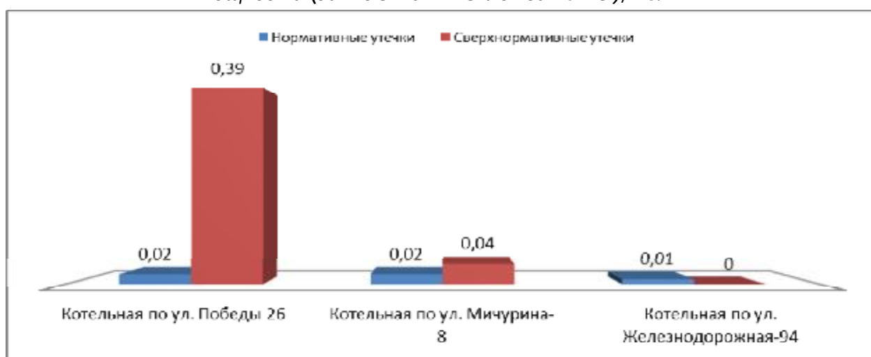
Рисунок 3.1.4. Объем воды на подпитку систем теплоснабжения котельных малой мощности (данные МУП «Тепло» за 2012г.), м³/ч.
